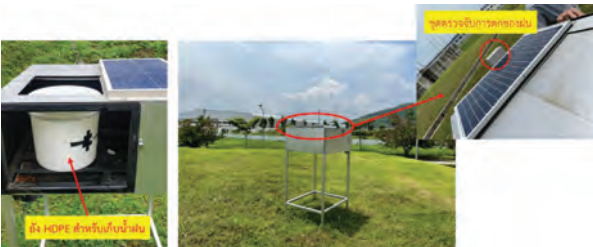
รูปที่ 3.1 เครื่องเก็บตัวอย่างน้ำฝนที่ได้พัฒนาขึ้น
